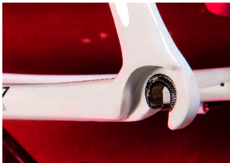
Congiunzioni in carbonio integrate sul telaio / Carbon drop out
